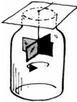
Vous avez déjà probablement vu ce curieux petit dispositif qui se met à tourner lorsqu'il est exposé à une lumière vive. Il se mettra à tourner aussi dans l'obscurité près d'un radiateur où même entre les paumes de vos mains... Dans l'ampoule où il règne un vide presque total, on a attaché un moulinet comportant quatre pales très légères, brillantes sur une face et noircies sur l'autre.
